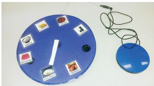
Figura 6 Relógio de comunicação de baixo custo e para realização de atividades pedagógicas. Confeccionado a partir da base do “pega-peixe”, cabo moeda e acionador de pressão.
