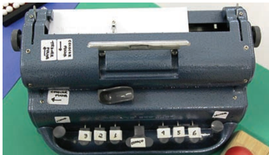
Figura 6 Máquina Perkins (o teclado apresenta os números que compõem a cela braille).
